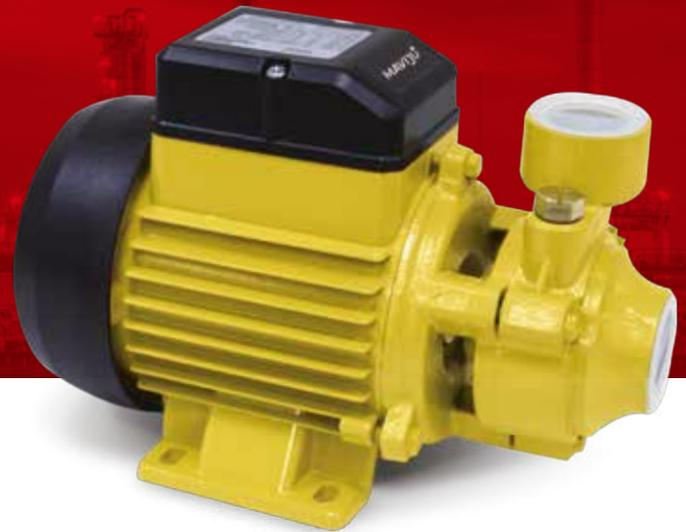
Son bombas periféricas, ideales para distribuir agua limpia en ausencia de cuerpos sólidos en suspensión o materiales abrasivos; este tipo de bombas producen remolinos en el líquido por medio de los álabes a velocidades muy altas, dentro del canal anular donde gira el impeller.
