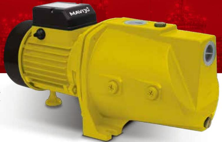
Son bombas centrífugas a las que se les ha acoplado un sistema eyector y difusor venturi, el mismo que la convierte en una bomba autocebante e incrementa su capacidad de altura de succión.
